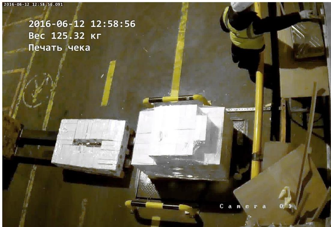
**Рис. 4 Наложение данных взвешивания с весовой платформы на изображении с видеокамеры**
