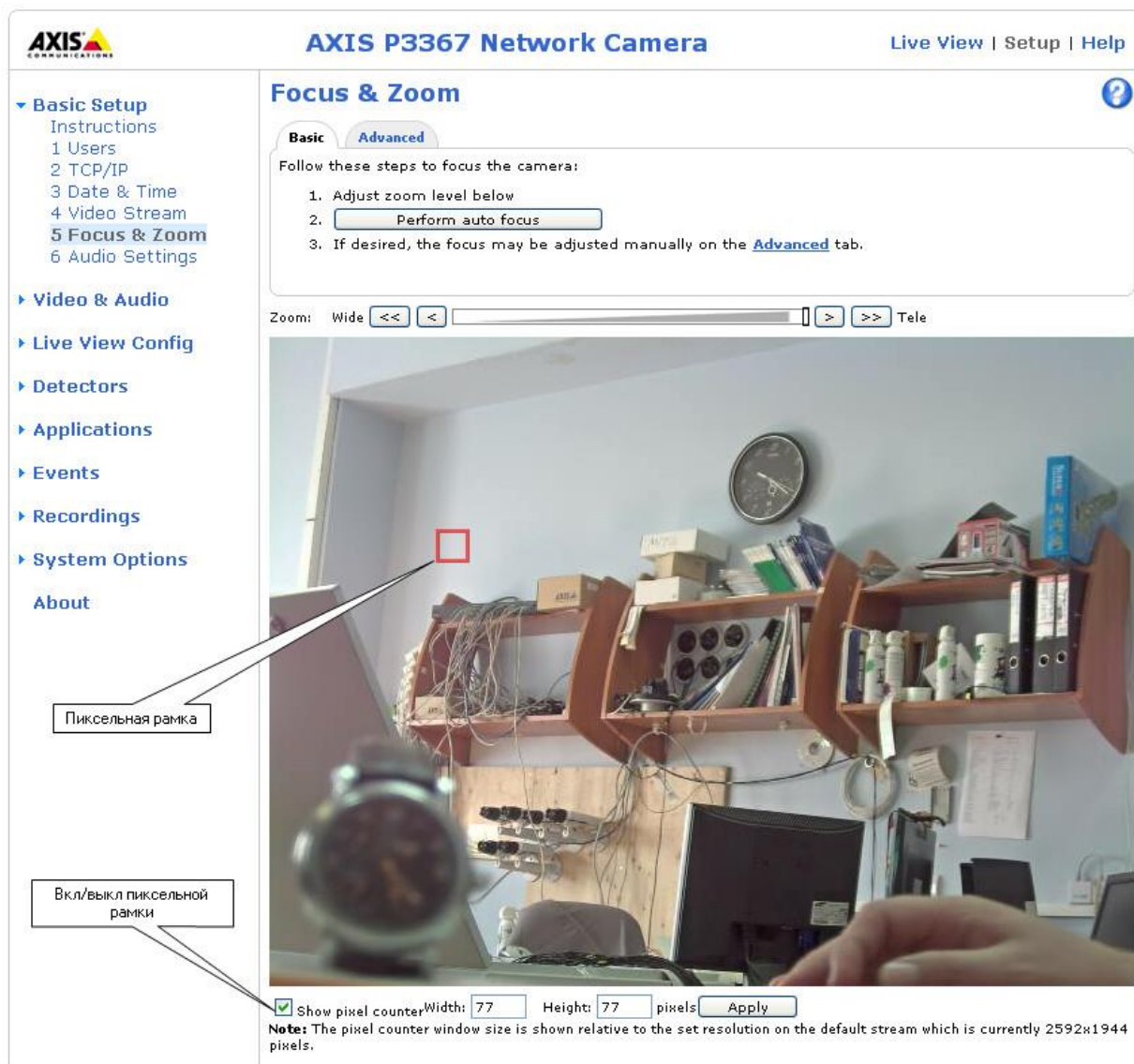
Рис. 3 Определение размера пиксельной рамки в камерах AXIS
