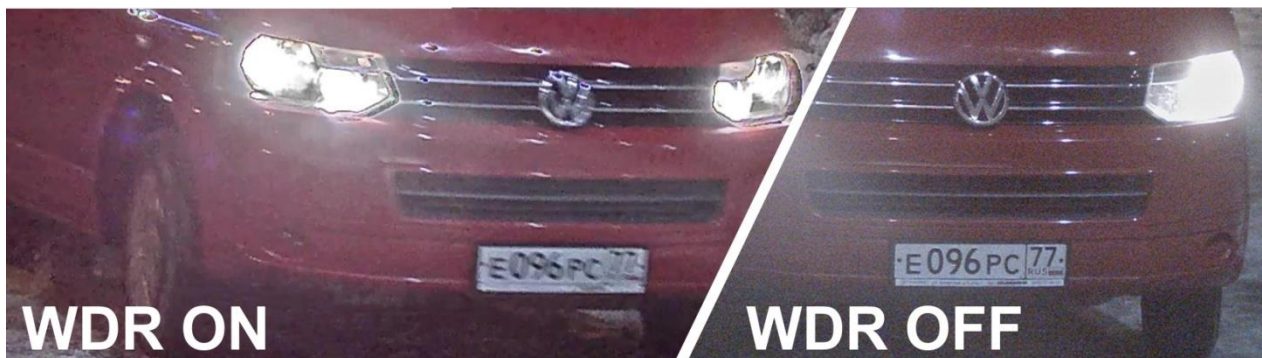
Рис. 4 Автомобиль в движении со включенным и выключенным WDR
