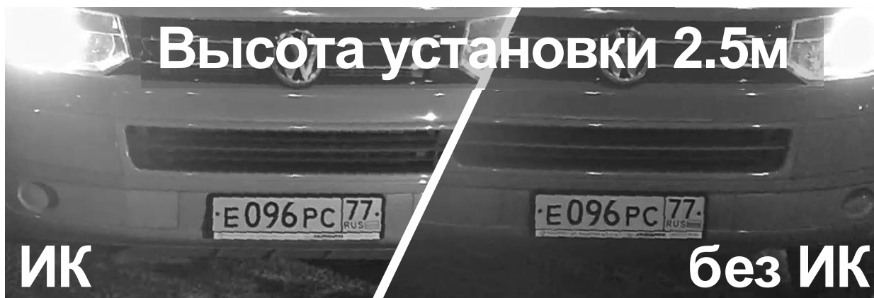
Рис. 6 Использование ИК подсветки для распознавания номеров
