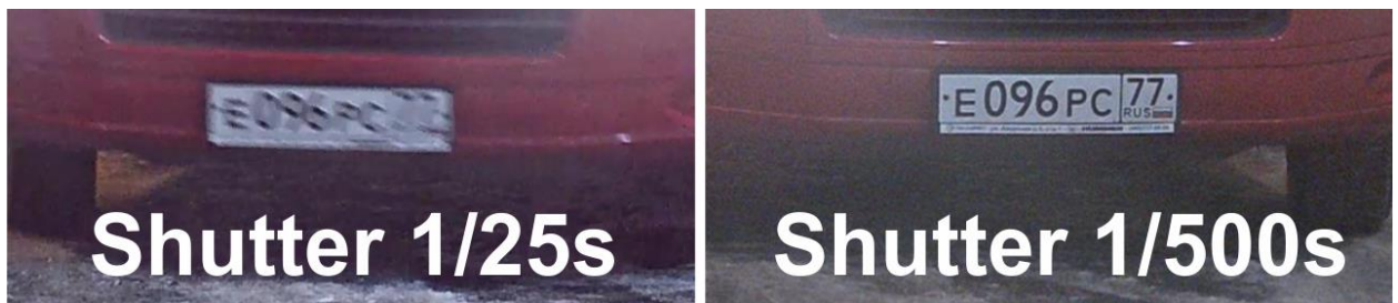
Рис. 3 Разница изображений движущегося автомобиля с различными параметрами выдержки
