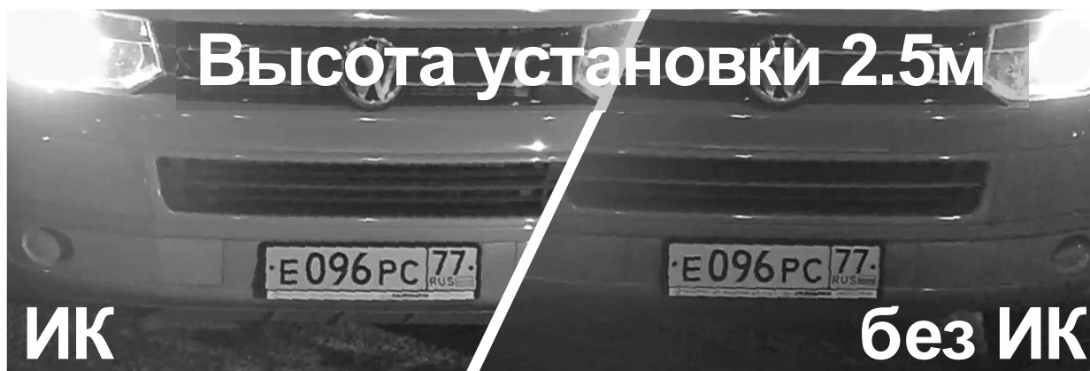
Рис. 6 Использование ИК подсветки для распознавания номеров
