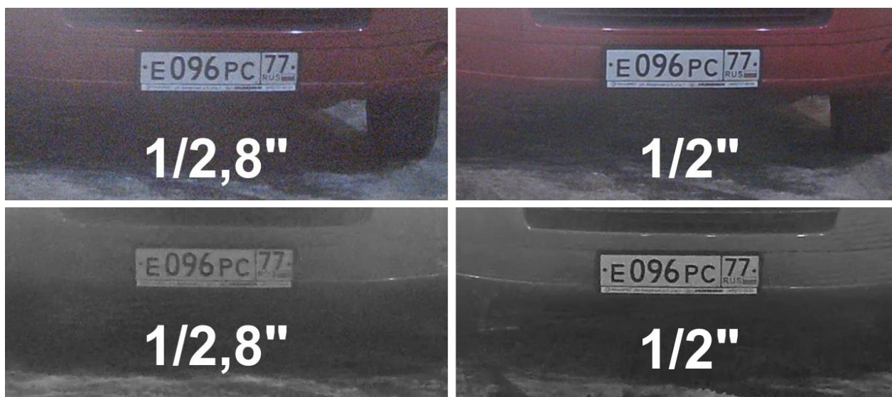
Рис. 2 Разница изображения номера на камерах с матрицами 1/2,8" и 1/2"
