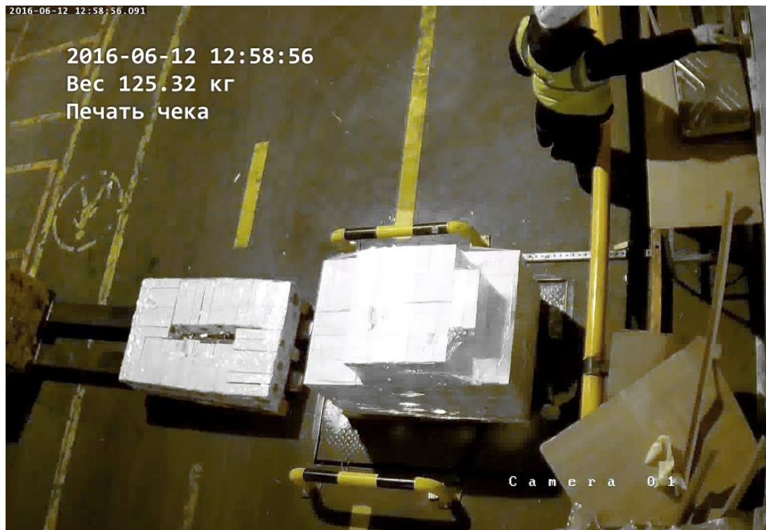
Рис. 4 Наложение данных взвешивания с весовой платформы на изображении с видеокамеры
