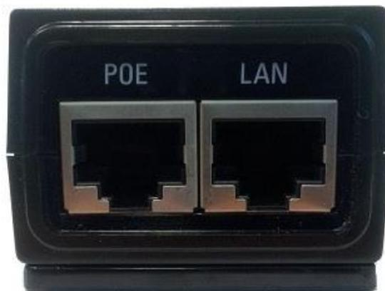
Рис. 8. Порты PoE-инжектора Ubiquiti PoE 24-12W. POE – питание устройств NanoStation, LAN – подключение к коммутатору локальной сети.
