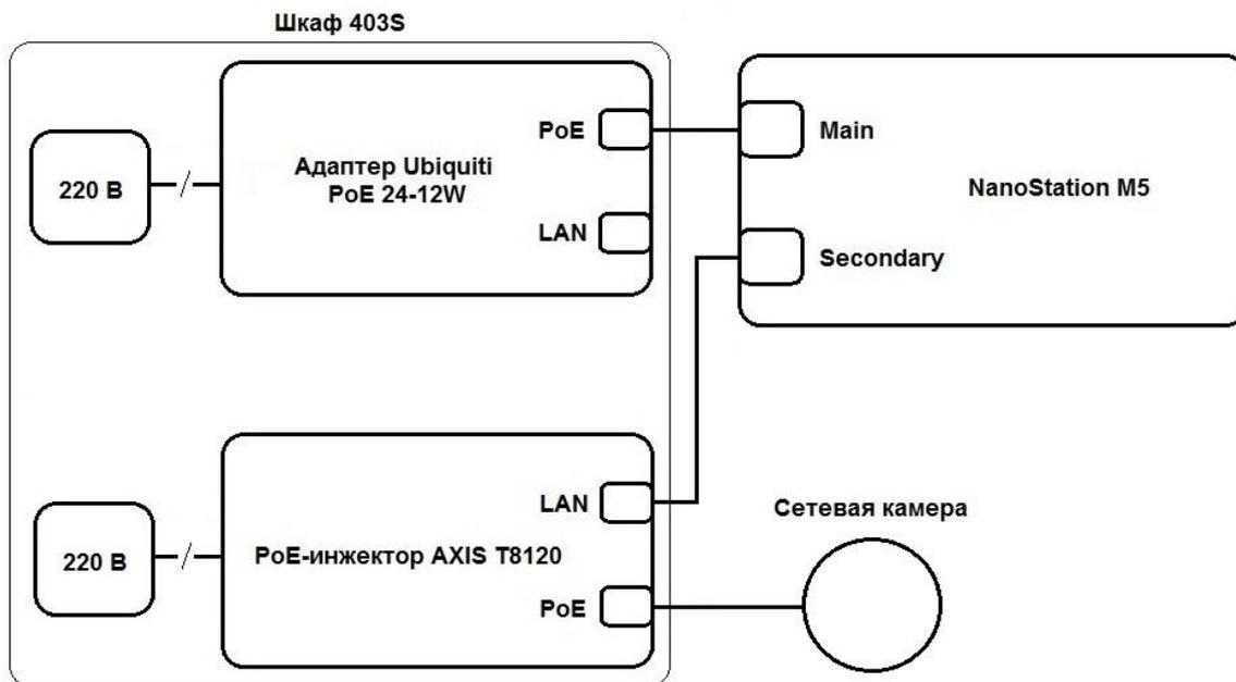
Рис. 6. Блок-схема подключения передающей станции и IP-камеры.
